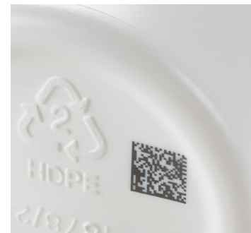
El sistema láser 7810 de Videojet utiliza las longitudes de onda ultravioletas para crear códigos permanentes de alta resolución en el proceso de envasado con materiales HDPE.
